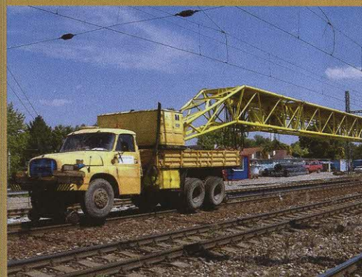
Obojživelný pokladač kolajových polí PKP 25/20 môže pracovať s polami dlhými 25 metrov s hmotnosťou do 25 ton. Za jednu pracovnú zmenu zvládne pokládku 1000 metrov koľaje.
