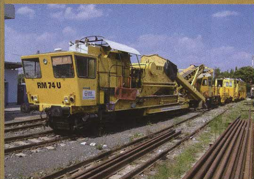
Strojná čistička Plasser a Theurer RM 74U je osvedčeným pomocníkom pri údržbe tratí. Za jednu pracovnú zmenu dokáže prečistiť 800 metrov koľaje
